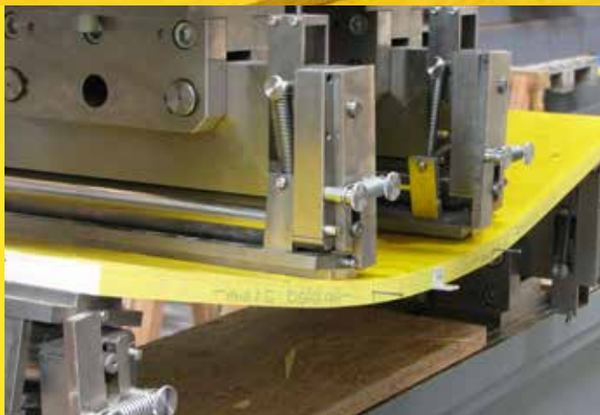
Laboratorijski test upogibne trdnosti opažne plošče (Tehnična univerza Graz / Austrija)
